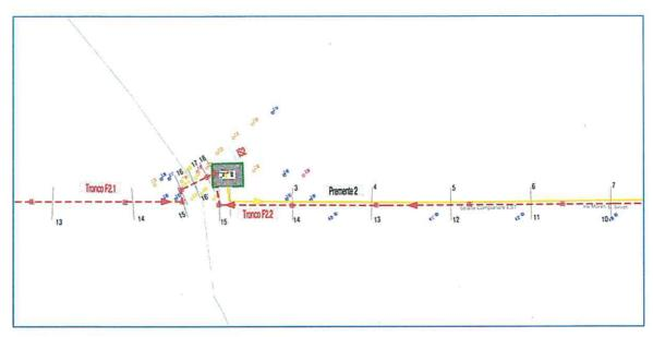
Tale circostanza determina nella configurazione prevista in progetto il raggiungimento di una quota di posa inferiore di circa 5 m rispetto al piano stradale della strada complanare ovvero a profondità tale da realizzare il collettore (F2.1) per un tratto di soli 10 m circa al di sotto della quota di attestazione della falda.
