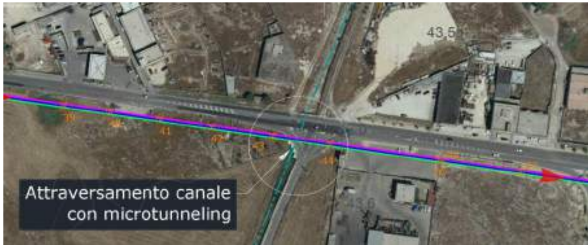
Figura 6 – Attraversamento Canale Scolmatore e attraversamento stradale esistente realizzato con tecnologia no-dig microtunnelling
