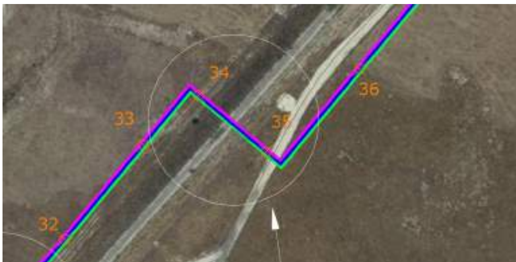
Figura 4 – Ubicazione planimetrica dell’interferenza con linea ferroviaria
